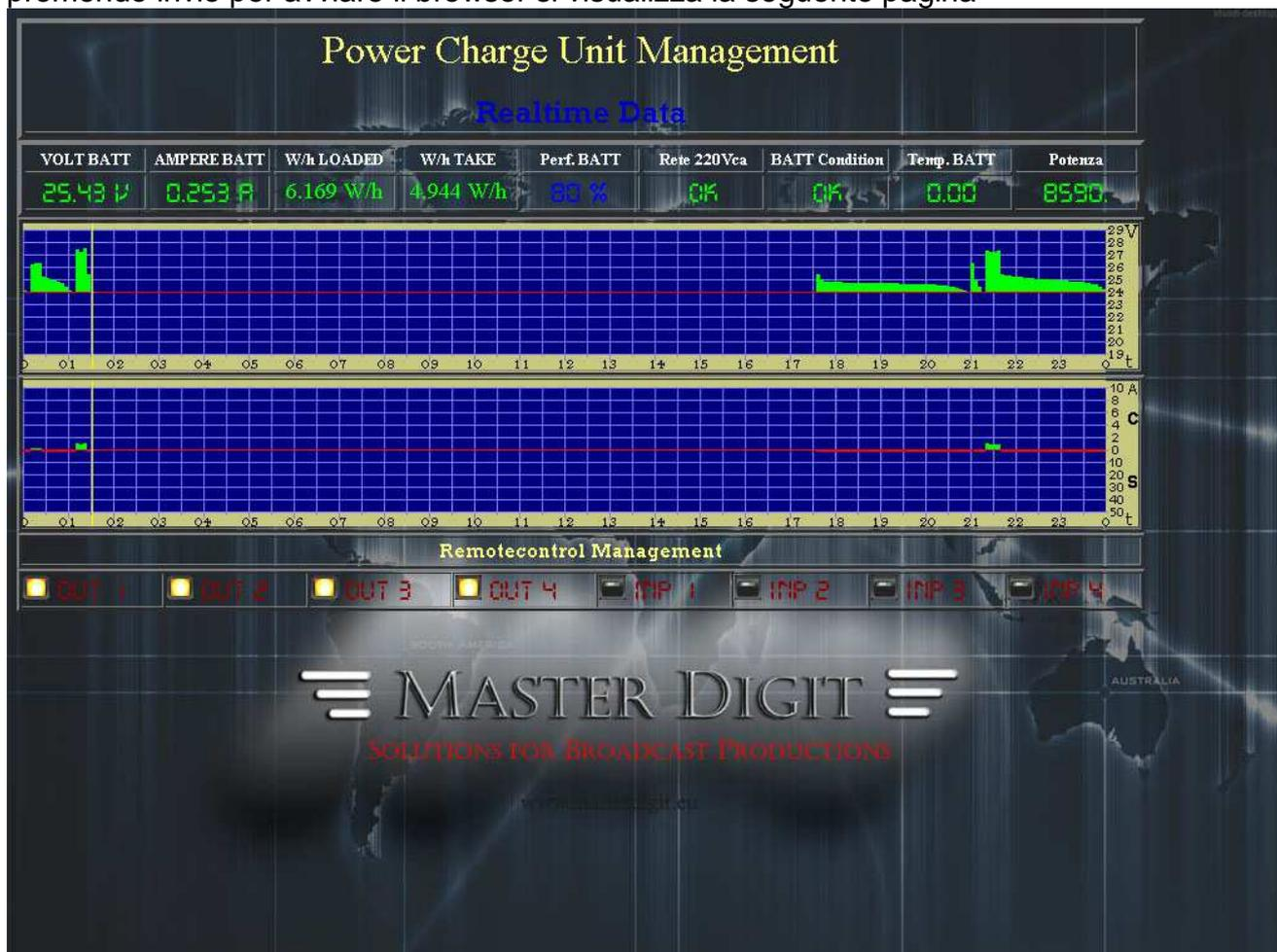
In questa pagina è possibile visualizzare i dati in tempo reale della tensione, gli Ampere di carica o scarica, i Watt/h accumulati e i Watt/h erogati nell'ultima mancanza di rete elettrica, la resa e la temperatura delle batterie, inoltre due finestre mostrano la presenza della rete elettrica e della connessione batterie.
